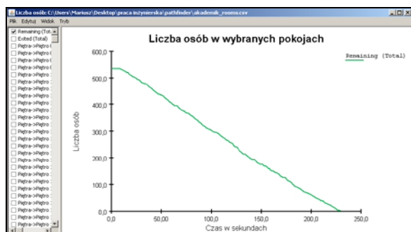
Rys.5 Wykres ewakuacji osób na podst. modelu zmienno-sterującego
