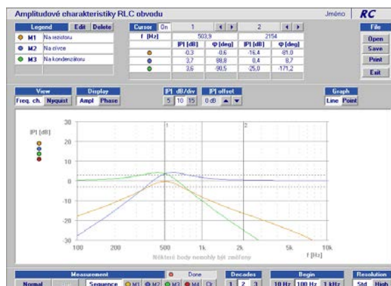
Obrázek 3. Amplitudové charakteristiky RLC obvodu
