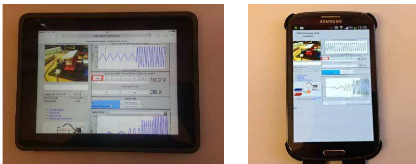
Ob. 10 Vzdálený experiment „Elektromagnetická indukce“, na mobilním zařízení iPad a na mobilním telefonu.
