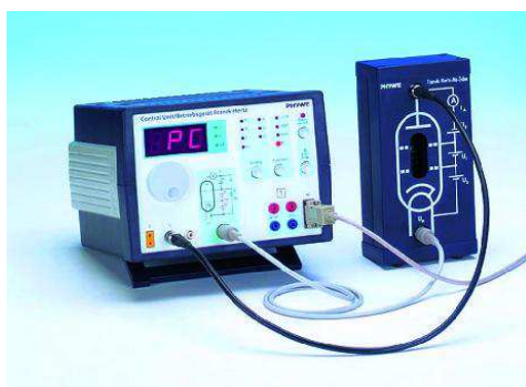
Obr. 7 Tovární laboratorní experiment „Franck-Hertz experiment“ firmy Phywe (vlevo), který je též implementovaný ve stavebnici iSES Remote Lab SDK (vpavo). http://194.160.213.12/index_js.html na PřF UKF Nitra, http://147.251.193.82/index.html na Ped fakultě MUNI v Brně.
