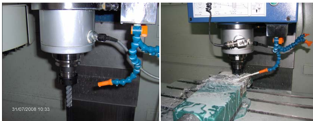
Obr. 2: Meranie vibrácií na vretene CNC stroja.
