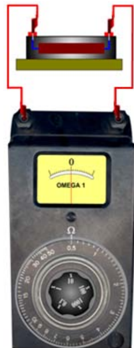
Obr. 2 Měření odporu přístrojem Omega
