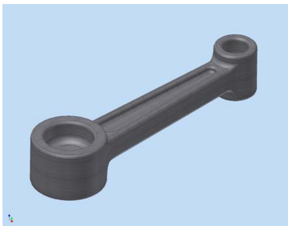
Obr. 1. Model výkovku ojnice
