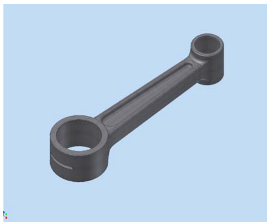
Obr. 2. Model obrobeného výkovku ojnice
